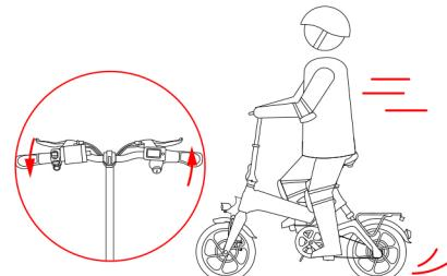
4. Сбавьте скорость, отпустив дроссель; и тормозите нажатием на тормозной рычаг.
